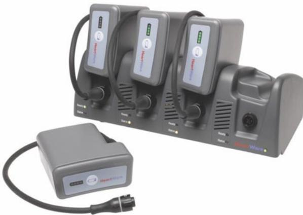
**Abb. 4** Ladestation für Akkumulatoren des HeartWare®-Systems [33]
